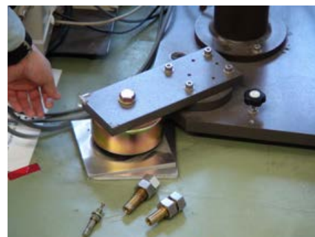
NMR の損傷状況。(上段)本震で傾いた 500 MHz 用超伝導マグネットと(中段)脚の拡大図。外れてめり込んでいる。(下段)400 MHz 用超伝導マグネットの耐震用アンカーは全て抜けているが、このマグネット自身に損傷はなかった。
